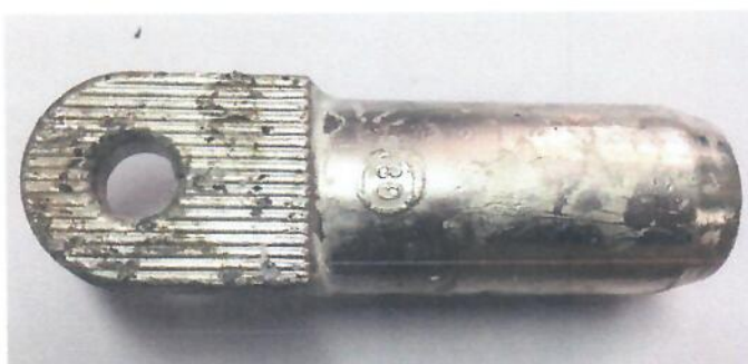
شکل ۲- تصویر نمونه‌ها پس از ۶ هفته قرار گرفتن در محفظه خوردگی
