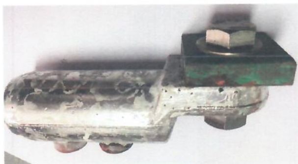
شکل ۲- تصویر نمونه‌ها پس از ۶ هفته قرار گرفتن در محفظه خوردگی
