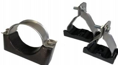
این نوع بست دارای یک کفی آلومینیومی و قسمت فوقانی ساخته شده از تسممه استیل می باشد. تسممه استیل این بست ها از نوع نگیر بوده و مقاوم در برابر خوردگی و عوامل محیطی می باشد. این نوع بست معمولاً به صورت تک سایز و برای کابل با یک قطر نهایی مشخص، طبق درخواست مشتری تولید می شود. این بست ها نیز در انواع سینگل کور و تریفویل قابل ارائه هستند.
