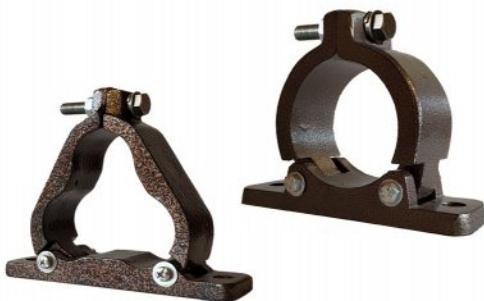
بست آلومینیومی در انواع سینگل کور و تریفویل تولید می گردد. این بست دارای دو ضلع لولایی جهت نصب آسان کابل می باشد. این نوع بست معمولاً به صورت تک سایز و برای کابل با یک قطر نهایی مشخص، طبق درخواست مشتری تولید می شود.
